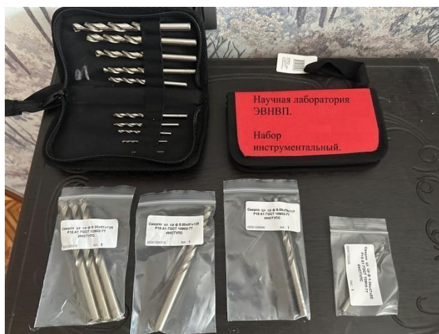
Рисунок 1 – Инструментальный набор сверл из стали P18. Поверхность сверл упрочнена покрытием из карбида вольфрама, полученным методом электровзрывного напыления
