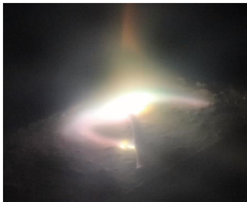
Рисунок 1 – иницируемая антенным эффектом СВЧ-плазма на керамики на основе Al_2O_3 .
