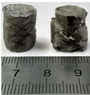
Рис. 2. Цилиндрические заготовки из магния, подвергнутые "осадке-выдавливанию" по двум сценариям
