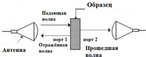
Рисунок 1. Схема установки для измерения в свободном пространстве
