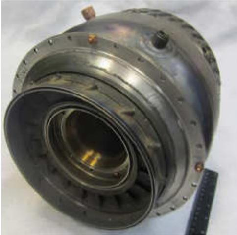
Рис. 1. Статорный узел с жаровой трубой и сопловым аппаратом из керамического материала
