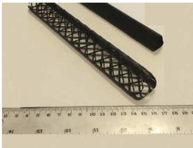
Рис. 2 Внешний вид труб: сплошной и сетчатой структуры
