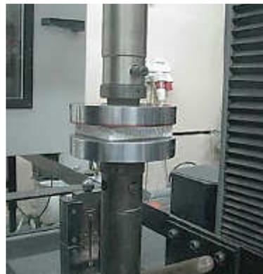
Рис. 2. Образец в процессе испытаний на сжатие
