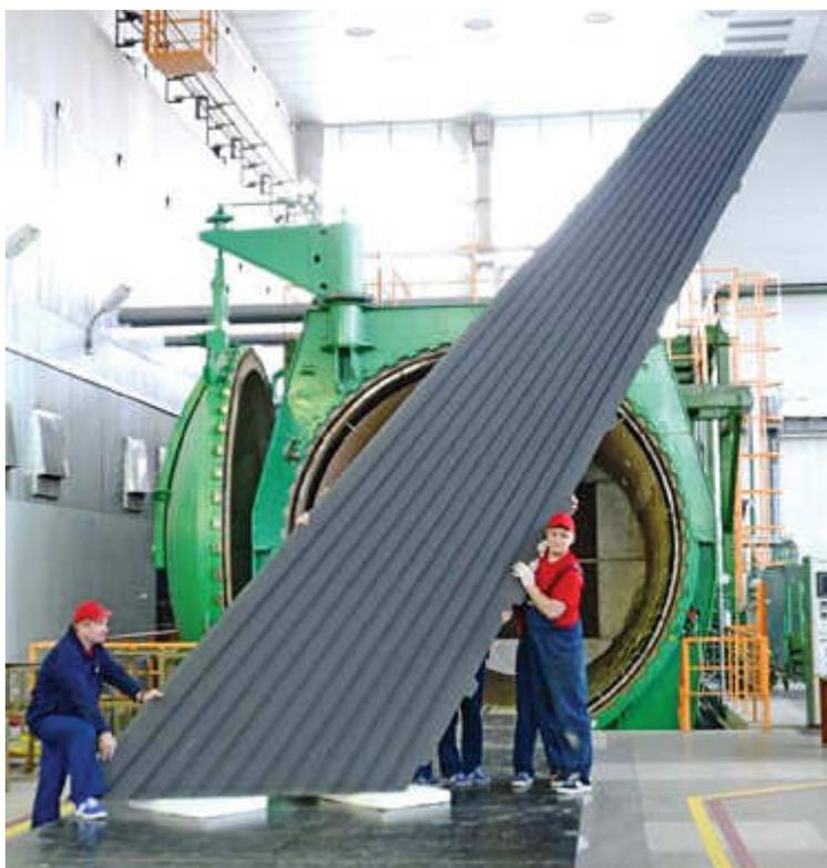
Рис. 1. Интегральная панель из углепластика кия самолета МС-21-300
