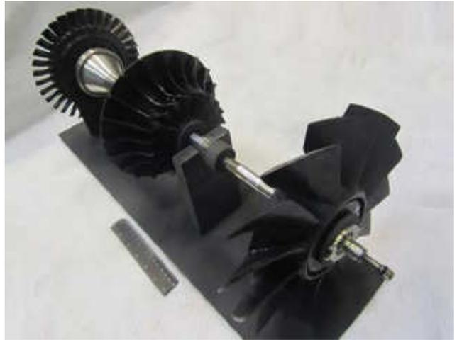
Рис. 2. Роторный узел с рабочими колесами низкого, высокого давления и турбины из композиционных материалов
