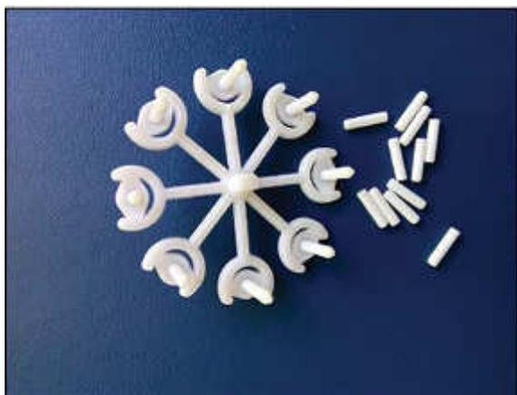
Рис. 1. Восьмиместная заготовка НОК 2,5 мм с литником (слева) и НОК 2,5 мм (справа)
