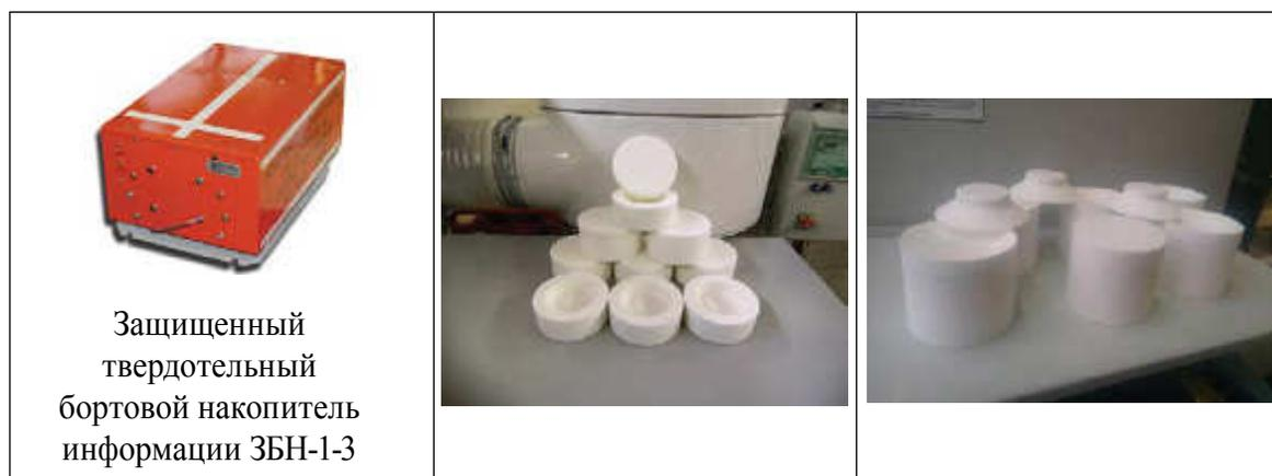
Рис. 1. Изделия из конструкционных теплоизоляционных материалов ТЗМ-23М и ТЗМК-10М для АО НПО «Прибор», г. Санкт-Петербург
