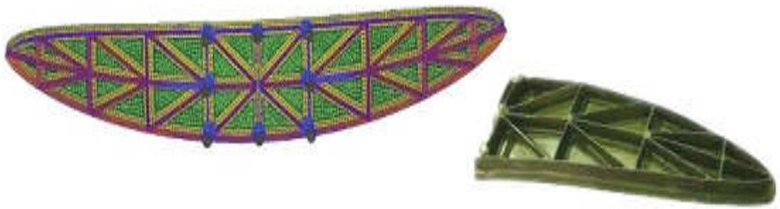
Рис. 2. Конечно-элементная модель зеркала. Фрагмент готового изделия
