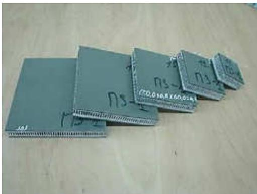
Рис. 1. Образцы для испытаний на сжатие
