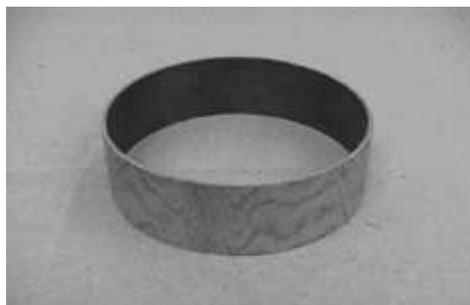
Рис. 2. Теплозащитная вставка для узла соединения шпангоут-обтекатель из КМ ХАФС
