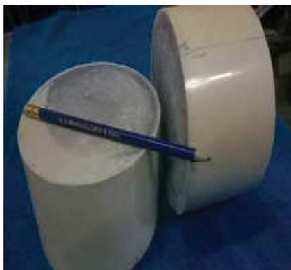
Рис. 2. Цилиндры диаметром 142 мм из BN
