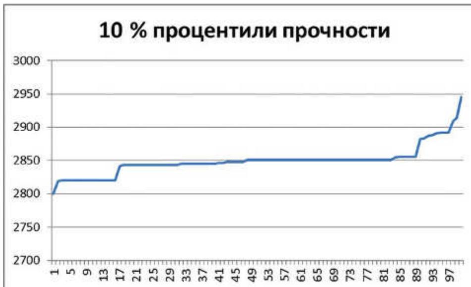
Рис. 2. Вариационный ряд распределения 10 % процентиля прочности материала, построенный по 100 бутстреп-выборкам
