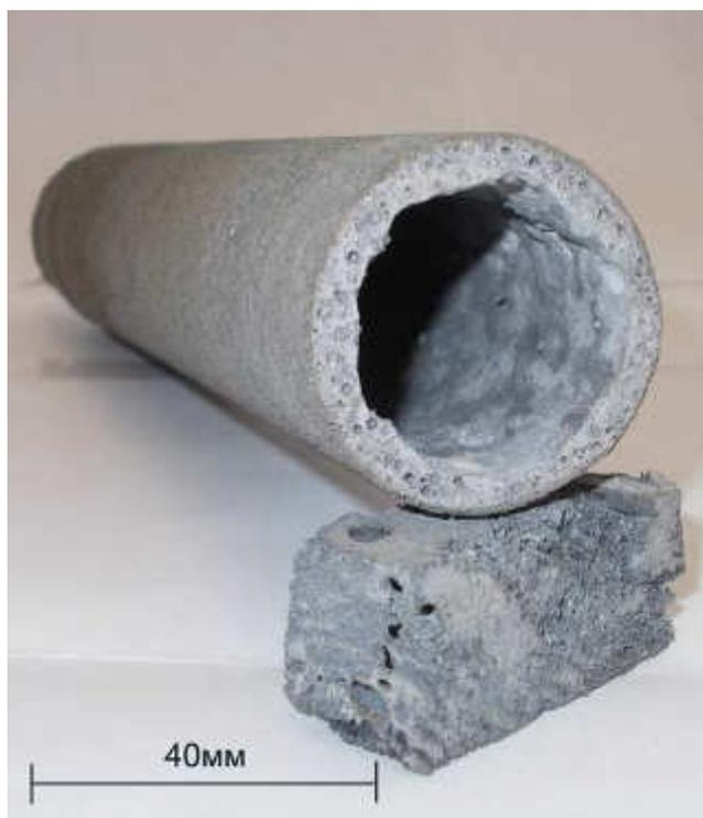
Рис. 2. Изделия из синтезированного материала, геометрия которых сформирована в процессе синтеза
