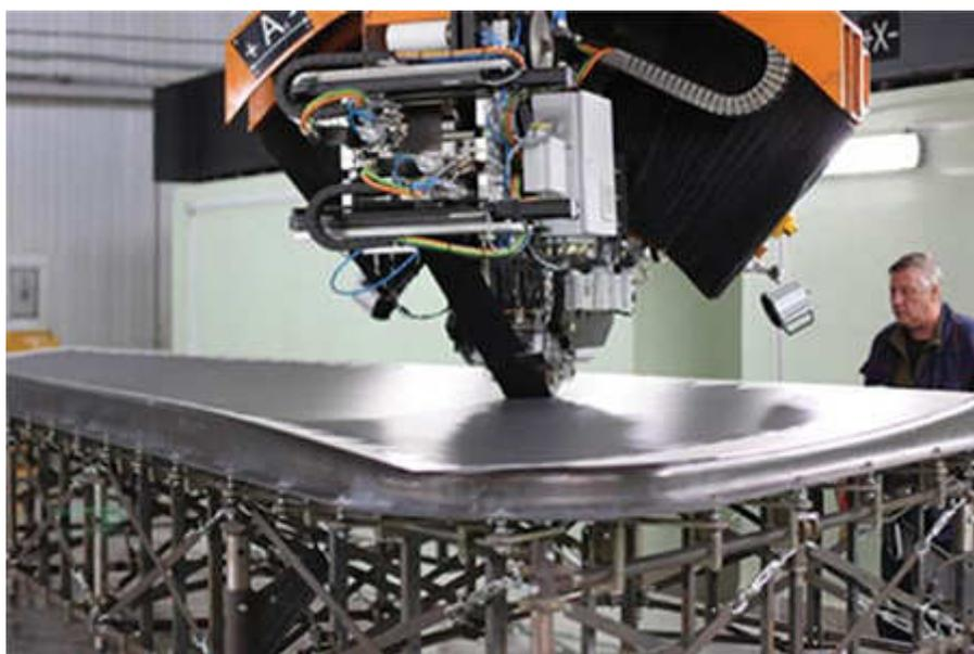
Рис. 5. Автоматизированная скоростная выкладка слоев препрега обшивки интегральной панели стабилизатора самолета МС-21-300
