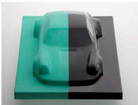
Достаточно нанести 2-3 слоя продукта Mikon® 399 MC для герметизации всех пор модельного пластика. После просушки при комнатной температуре в течение 5 минут уникальный состав продукта обеспечивает глянцевую поверхность без дополнительной механической обработки и полировки.
