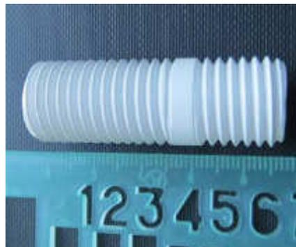
Рис. 4. Шпилька М16х2 из нитрида бора
