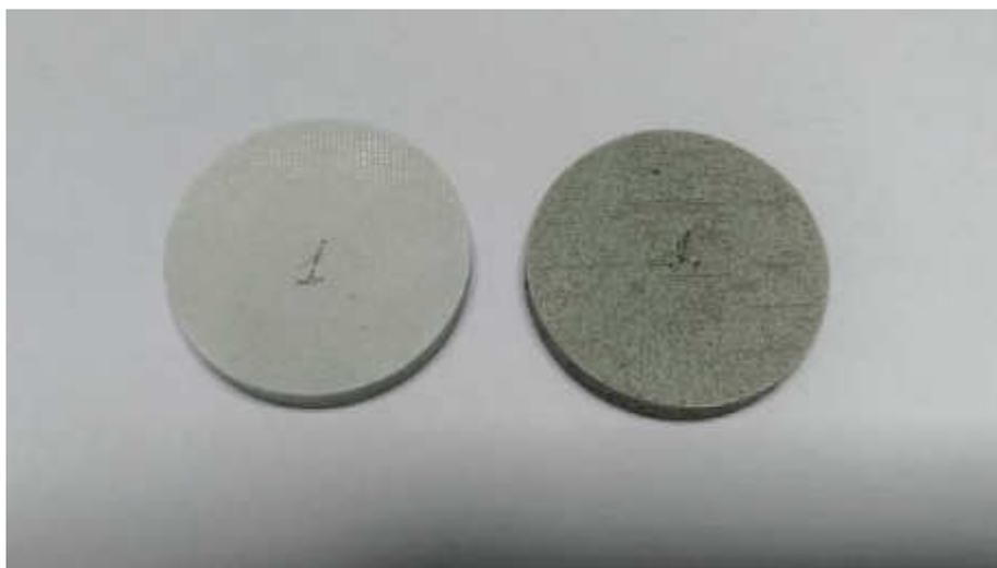
Рис. 1. Образец (слева) с нанесенным неорганическим покрытием КФСШ-60, образец из КМ ХАФСкв (справа) без покрытия
