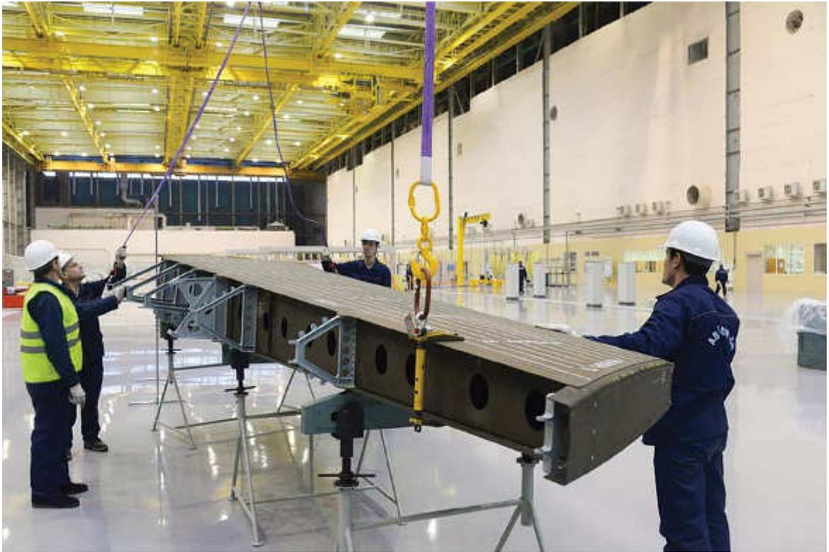
Рис. 6. Углепластиковый кессон киля самолета МС-21-300
