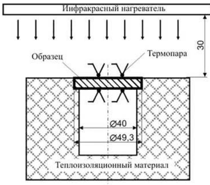
Рис. 1. Схема испытания образца при высокоскоростном одностороннем нагреве
