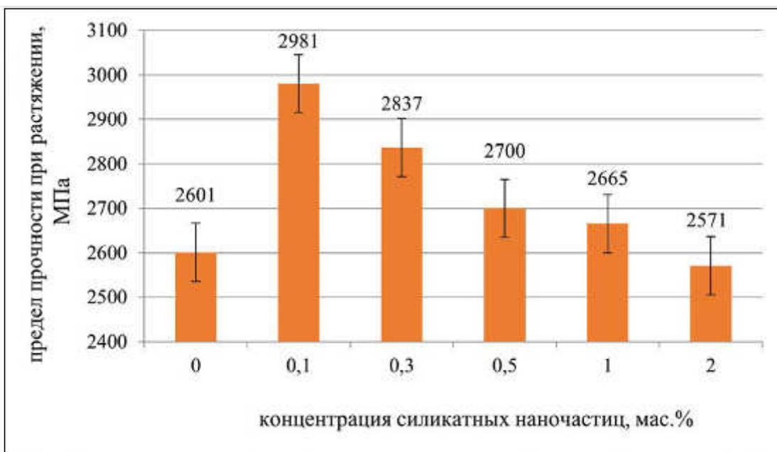
Рис. 3. Зависимость предела прочности при растяжении от концентрации А-300
