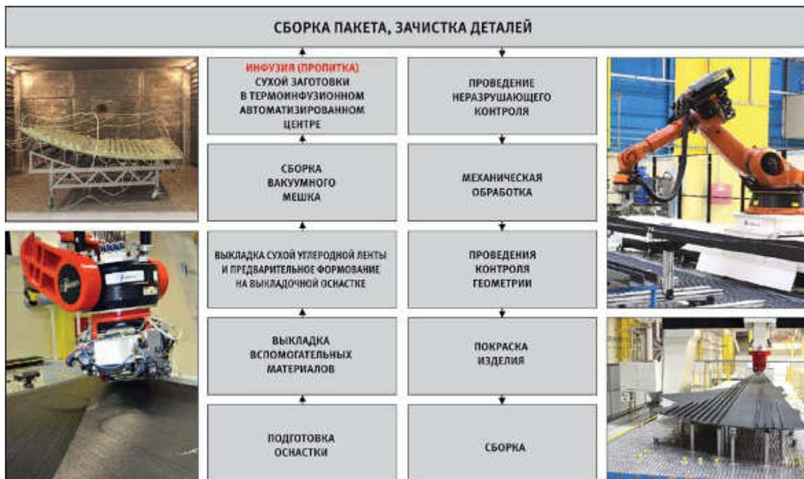
Рис. 1. Технологический процесс создания композитных элементов конструкций методом вакуумной инфузии
