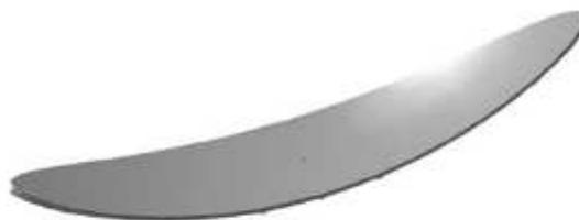
Рис. 1. Вид рабочей поверхности антенного зеркала
