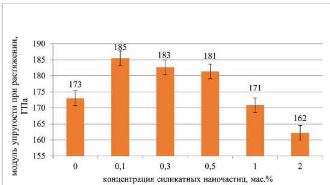
Рис. 2. Зависимость модуля упругости при растяжении от концентрации А-300
